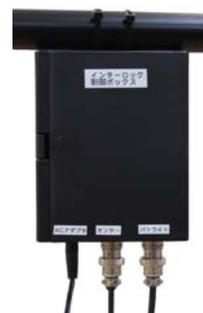
制御ボックス内のスイッチを切り替えることで、カーテンを閉じた時、または開いた時のON設定が出来ます。
