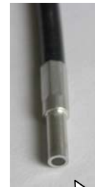
ライトガイド光入射部分 入射口径 \phi 3 ガラス ステンレス ガイド外形 \phi 4.8
